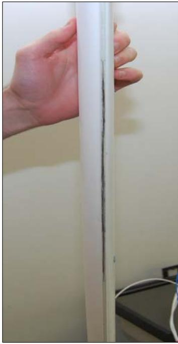
Figure 5 Edge Crack
